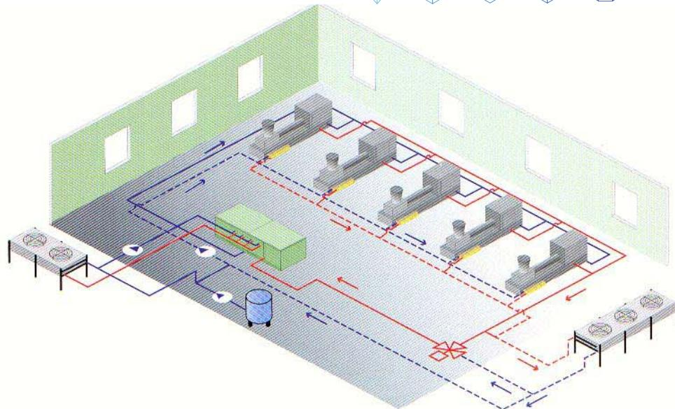
**Wasserkondensierende Kühlmaschine verbunden mit einem Freikühler.** Zusätzlich mit Freikühler für den Hydraulikkreislauf und mit automatischem Anschluß an den Niedrigtemperaturkreislauf.
