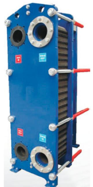
Le piastre di scambio termico sono principalmente costituite da fogli di lamiera in acciaio inox SS304, SS316, SMO, Hastelloy o Titanio, dallo spessore compreso tra 0,5 mm e 1 mm. A seconda del tipo di applicazione e del fluido, il materiale delle piastre e delle guarnizioni può subire variazioni.
