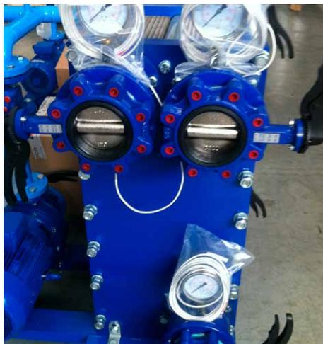
Scambiatore per recupero di calore acqua motore (jacket/aftercooler) e olio
