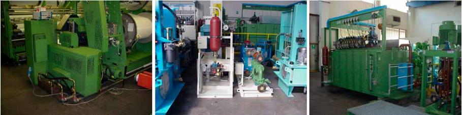
Scambiatori di calore a piastre rispettivamente su centrale oleodinamica, centralina di lubrificazione e impianto oleodinamico
