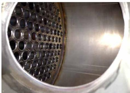
Scambiatore recuperatore fumi/acqua per impianto di cogenerazione
