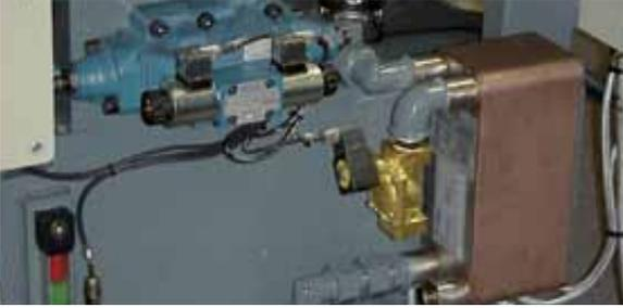
Scambiatore di calore a piastre su centralina oleodinamica
