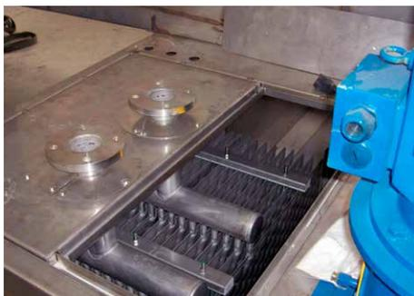
Scambiatori T COIL per riscaldamento dell'olio di palma
