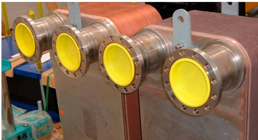
Particolare di scambiatore a piastre per aria compressa
