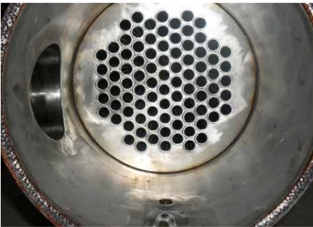
Tubi diritti scovolabili in scambiatore fumi per impianto di cogenerazione a motori endotermici alimentati a gas naturale
