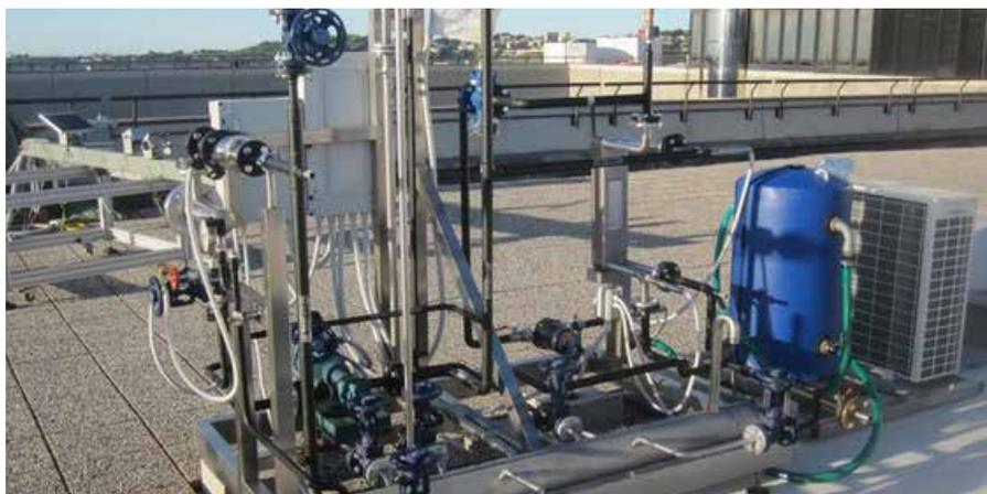
Test Bench per test di prova con acqua e olio diatermico in impianto solare termico a collettore
