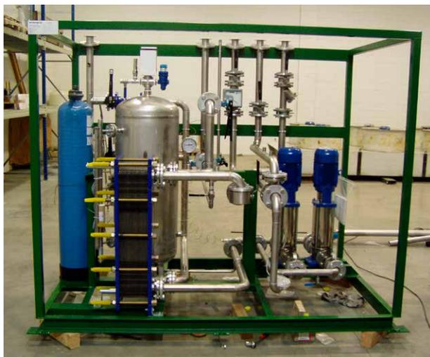
Centralina di termoregolazione T REG per inverter di potenza
