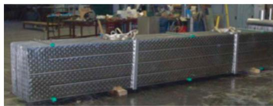
Questa peculiare flessibilità costruttiva consente di poter estendere l'applicazione degli scambiatori T COIL ad una serie notevole di applicazioni in ambito del raffreddamento e riscaldamento di processi produttivi:
