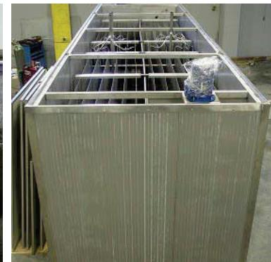
Gli scambiatori della serie T COIL, sono scambiatori primari molto versatili ed efficienti, che vengono realizzati con un metodo semplice ed efficace: due lamiere saldate perimetralmente e tramite puntatura, vengono rigonfiate mediante elevata pressione, per ottenere una canalizzazione interna che crea una serie di passaggi per il fluido di trasferimento del calore.
