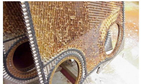
Le piastre possono essere pulite sul posto (CIP, cleaning on site). Altrimenti, il blocco piastre deve essere portato in officina dove verrà controllato, provvedendo alla pulizia e alla eventuale sostituzione delle vecchie piastre, riportandolo alle condizioni di progetto. Un controllo di manutenzione periodico è la soluzione più veloce, pratica ed economica.
