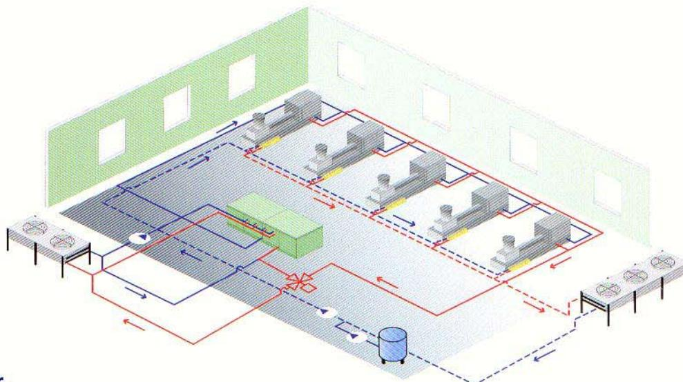
**Modulare Wasserkühlmaschine verbunden mit einem Freikühler.** Zusätzlicher Freikühler für den Hydraulikkreislauf.
