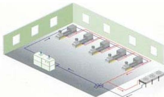
**Free-cooler** per il raffreddamento dell'olio idraulico e con collegamento automatico anche con il circuito bassa temperatura.
