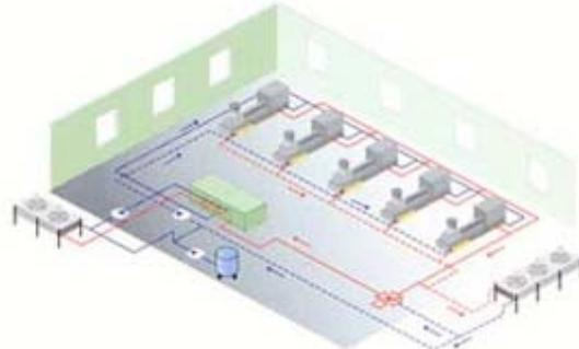
**Refrigeratore modulare condensato ad acqua integrato con free-cooler** per un apporto gratuito di energia nel periodo invernale. Circuito indipendente per l'olio idraulico con free-cooler.
